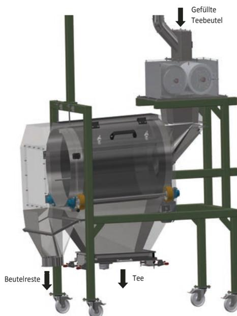
Kapselschlitzer für Kaffee-Kapseln hat HM Anlagentechnik bereits. Jetzt können auch Teebeutel aufgeschlitzt werden. Damit wird der Rohstoff Tee wiederverwertbar. Immer wieder gibt es in der Produktion fehlerverpackte Beutel, bei denen das Gewicht in der abschließenden Qualitätskontrolle nicht stimmt. Bislang wurden diese Verpackungen samt Inhalt unbrauchbar. Gemeinsam mit dem Kunden hat HM Anlagentechnik jetzt einen Weg gefunden, den darin enthaltenen Tee wieder in der Produktion einzusetzen.
